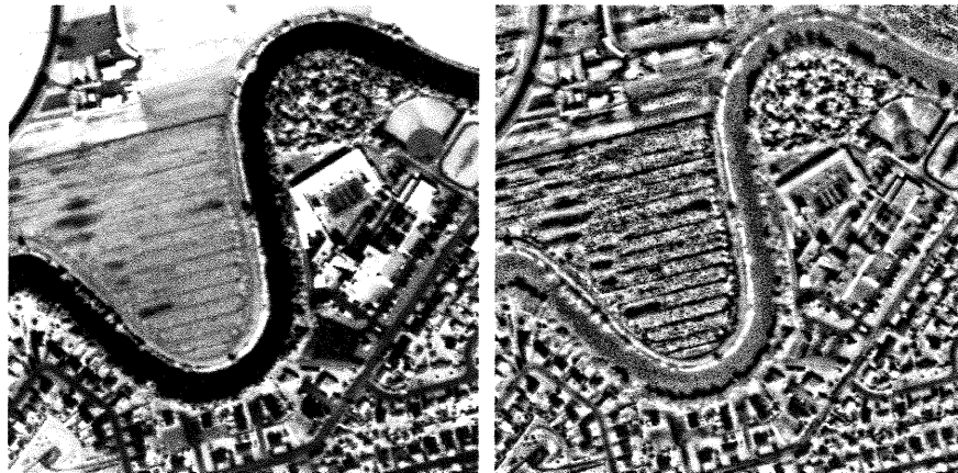
Figure 8b: Sous-image B initiale (à gauche) et égalisée localement (à droite).
