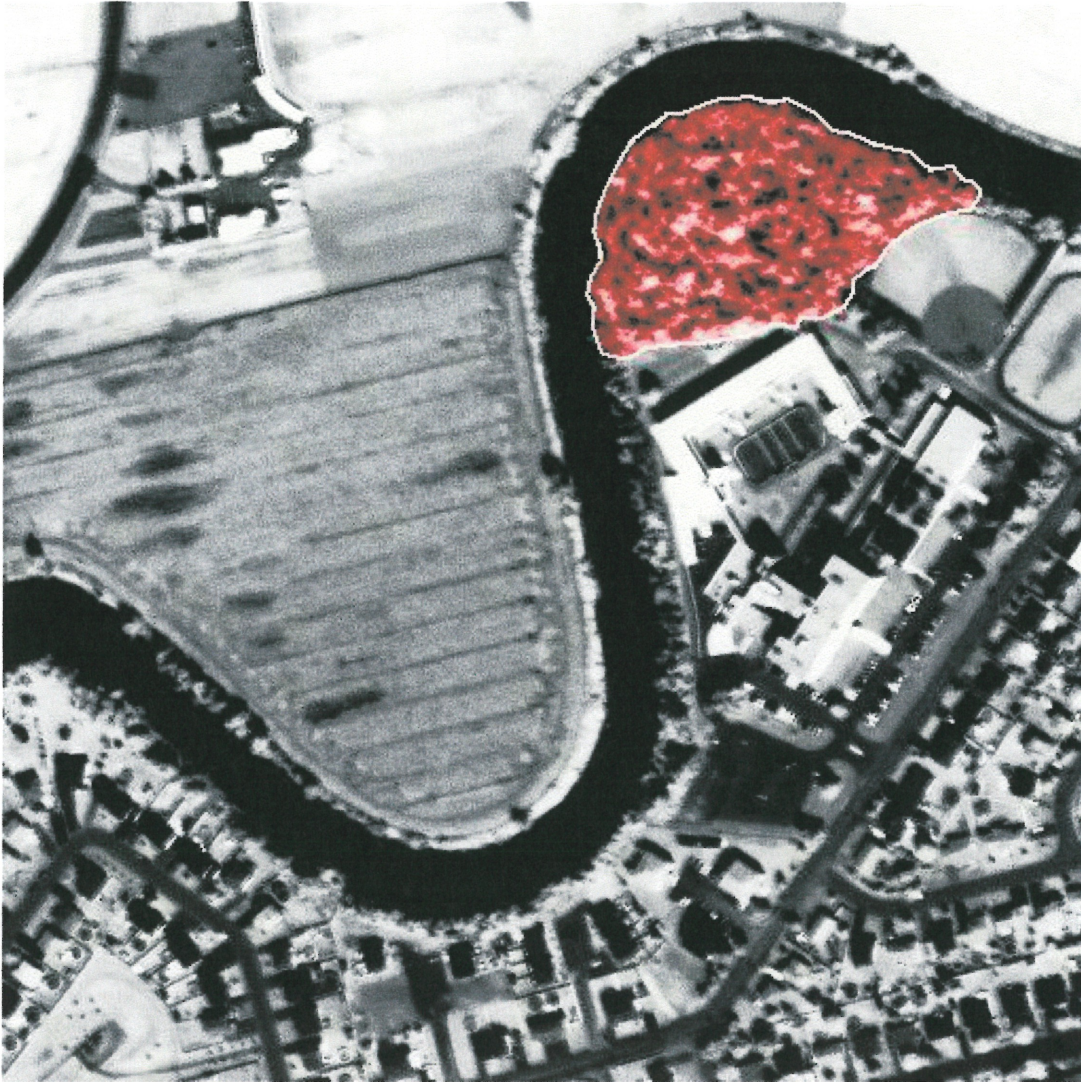
Figure 11b: Masque de vérité-terrain pour les surfaces boisées (sous-image B).
