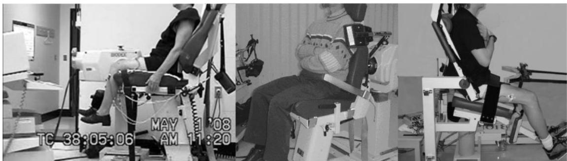
Photo 1. Dynamomètre Biodex et courroies de stabilisation
