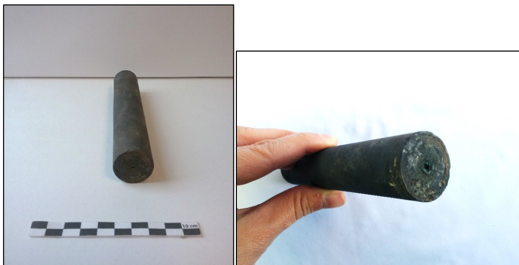
Figure-A.33.– Bâton en graphite faisant partie d'une batterie de téléphone (Source : L. Bolduc)
