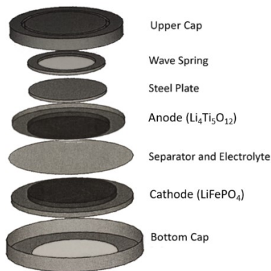
Figure 2.3. Schéma d'une pile bouton avec ses différents composants. Adaptée de la référence 1. 1
