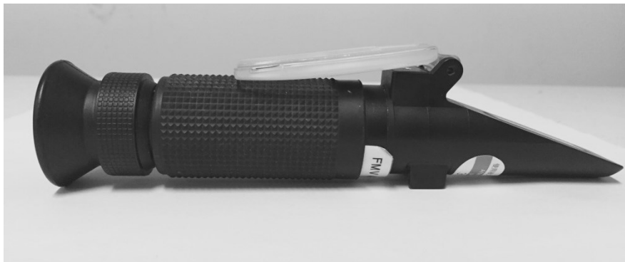
Figure 4 : Exemple de réfractomètre optique (crédit photo : Marie-Pascale Morin)
