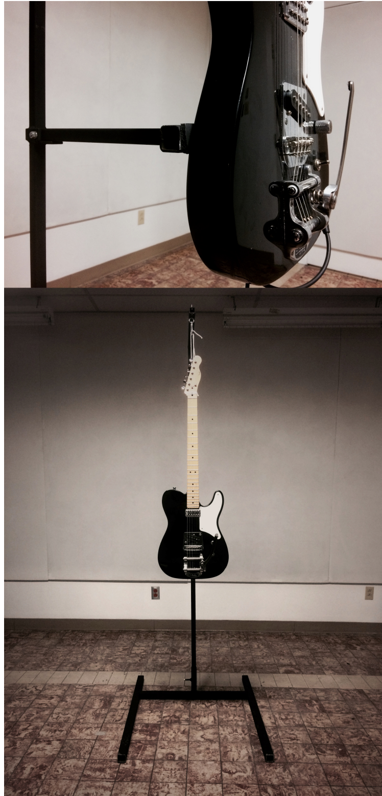
Figure 13 : Dispositif de suspension de la guitare avec vue sur le bras amovible qui permet de retenir la guitare pour la manipuler, ou bien de la laisser libre d'osciller.
