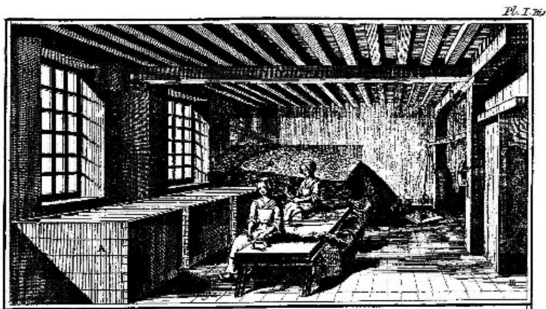
Figure 6 : Délissage. Source : Diderot, D. et D'Alembert, J., op. cit., Planche I
