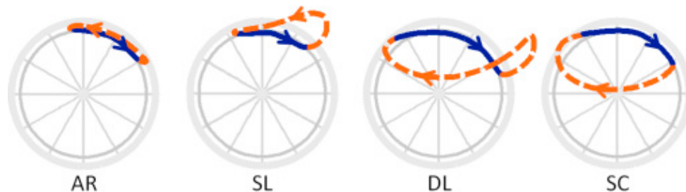
Figure 2.5 Les quatre patrons de propulsion les plus communs sont en arc (AR), en simple boucle (SL), en double boucle (DL) et le patron semi-circulaire (SC). Les lignes pleines représentent la phase de poussées alors que les lignes pointillées représentent la phase de récupération. Tirée de Slowik, Requejo, Mulroy et Neptune (2016).
