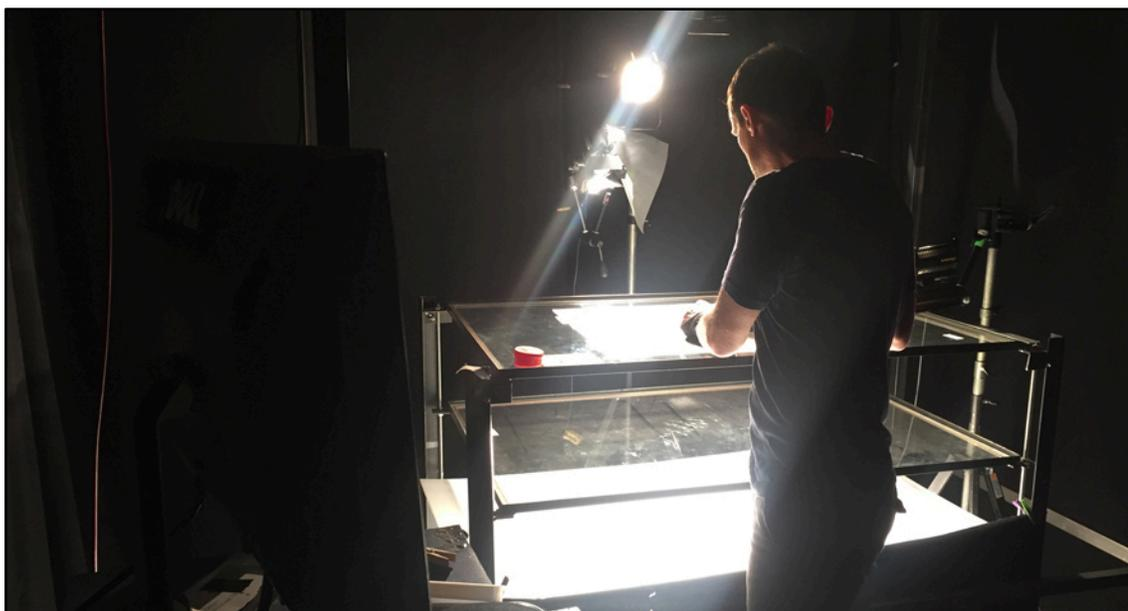
Figure 24. Image du dispositif pour le tournage en papier découpé (table multiplane rétroéclairée et éclairage frontal du dessus). Crédit : Janice Nadeau.
