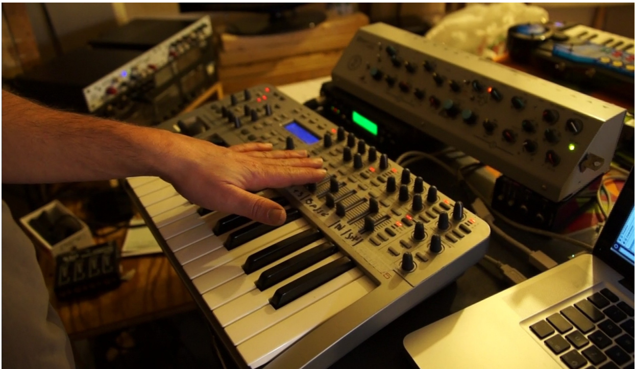
Fig. 8 : synthétiseur contrôlant le logiciel Ableton live et Sherman filterbank (haut).
