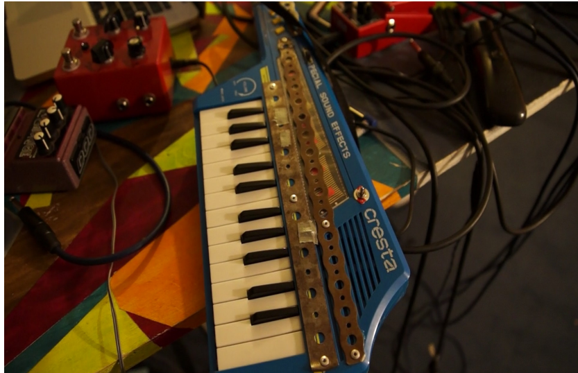
Fig. 12 : clavier bandoulière en circuit bending La Cresta.
