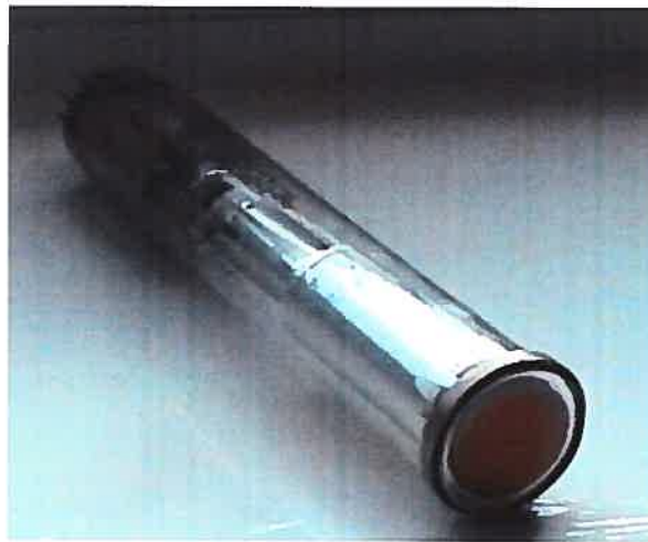
Fig. 9: En haut : Schémas de fonctionnement d'un tube Viticon. En bas : Photo d'un tube Viticon.
