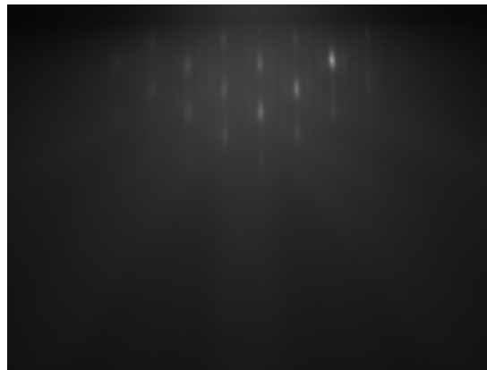
FIGURE 5.1 – Figure de diffraction RHEED lors de la croissance de l'échantillon InGaSb08B.
