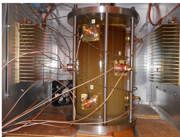
Figure 6.5 – Détecteur 93 dans le contrôleur de température et pression (TPCS) avec les capteurs piézoélectriques à gain intégré.
