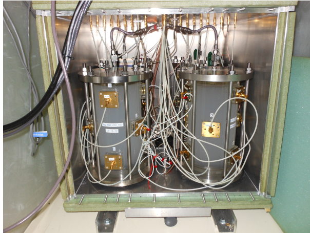
Figure 4.3 – Quatre des trente-deux détecteurs PICASSO dans un système de contrôle de la température et de la pression à SNOLAB.
